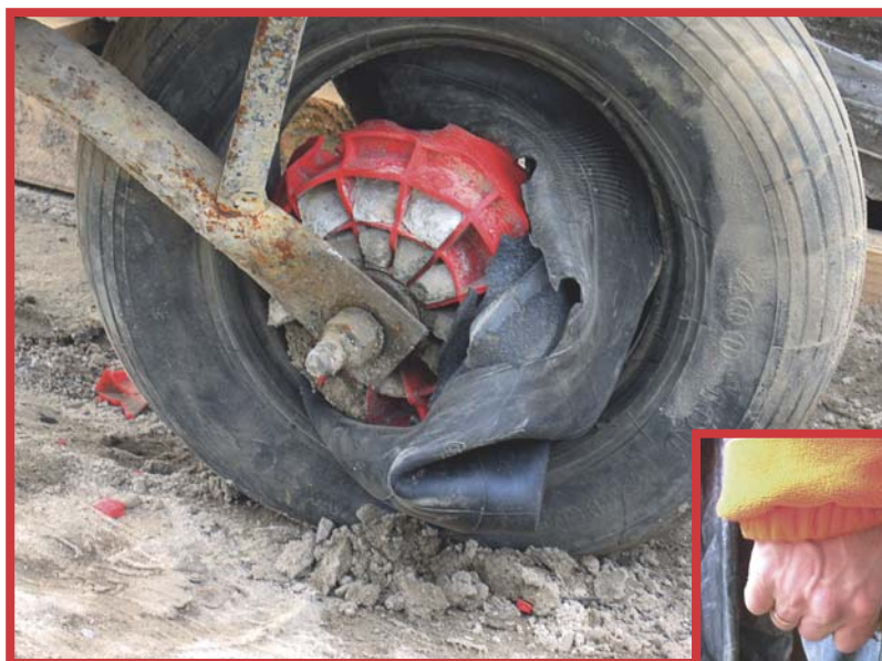
Efekt pompowania koła kompresorem – wypadek ciężki (uszkodzenie oka odpryskiem tworzywa)
