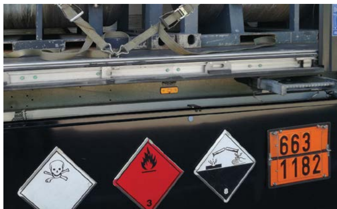
Powtórzone oznakowanie z nalepkami ostrzegawczymi i pomarańczową tablicą na pojeździe, który przewozi cystenę przenośną.
