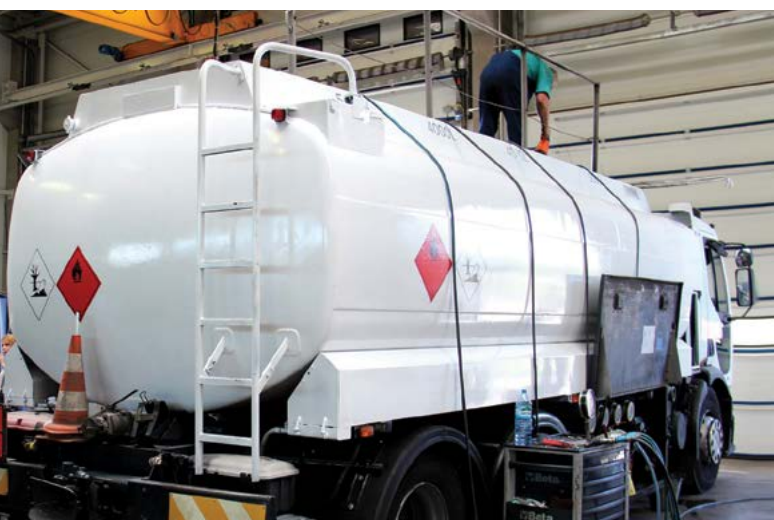
Cysterna w trakcie wykonywania próby ciśnieniowej, hydraulicznej niezbędnej do przeprowadzania badania okresowego.
