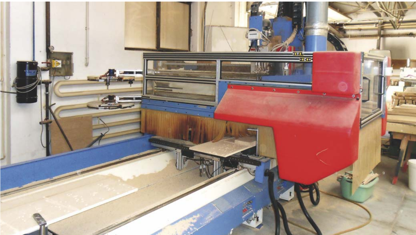
Fot. 1. Centrum obróbcze z systemem elementów naciskowych bezpieczeństwa (zderzak koloru czerwonego).
