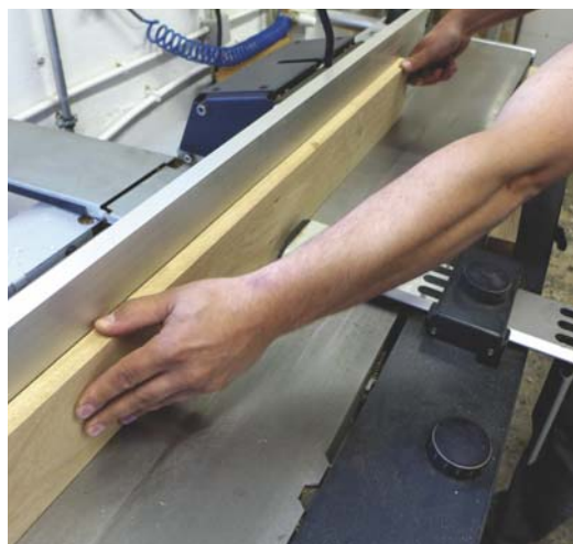
Fot. 8. i 9. Przykłady zamocowania osłony mostkowej na strugarce wyrówniarce podczas strugania płaszczyzny elementu i jego wąskiej krawędzi oraz prawidłowego ułożenia dłoni operatora.
