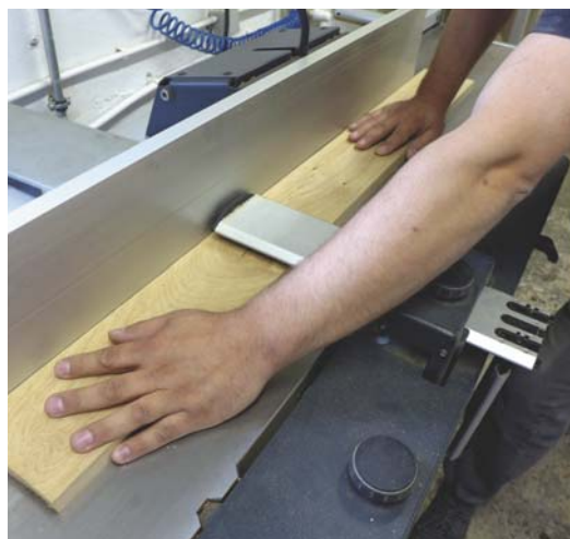
Fot. 8. i 9. Przykłady zamocowania osłony mostkowej na strugarce wyrówniarce podczas strugania płaszczyzny elementu i jego wąskiej krawędzi oraz prawidłowego ułożenia dłoni operatora.
