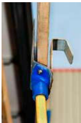
Narzędzie do demontażu poziomych desek przyczepy
