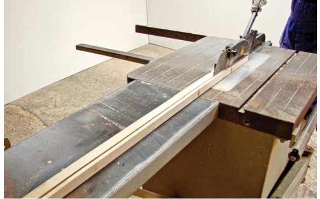
Wyposażenie stanowiska w stół przedłużony przy cięciu długich przedmiotów.
