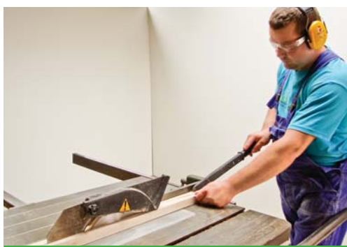
Używanie popychacza w końcowej fazie cięcia wzdłużnego.
