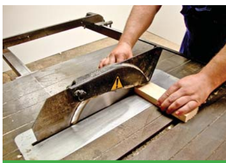
Ustawienie górnej osłony piły, dostosowane do wysokości ciętego materiału.
