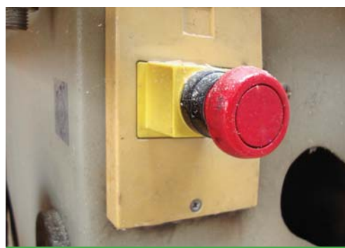
Przycisk zatrzymania awaryjnego (w kształcie grzybka o barwie czerwonej na żółtym tle).
