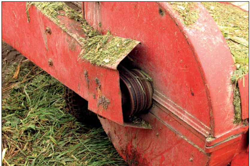
Fot. 7. Wszystkie ruchome, ostre i niebezpieczne elementy maszyn muszą być zabezpieczone solidnymi, kompletnymi osłonami, o odpowiedniej wielkości.
