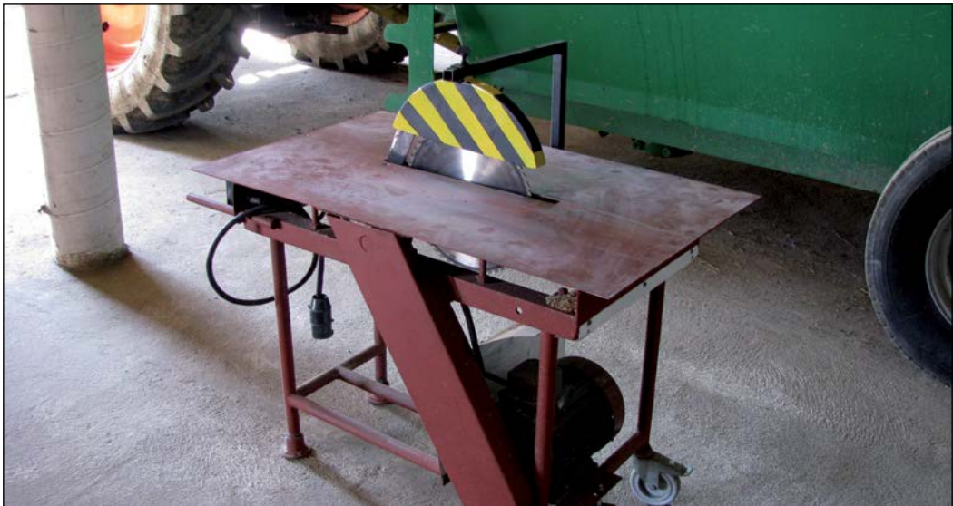
Fot. 9. Najbezpieczniejsze są oryginalne osłony, ale zabezpieczenia wykonane według własnego pomysłu też mogą być skuteczne.
