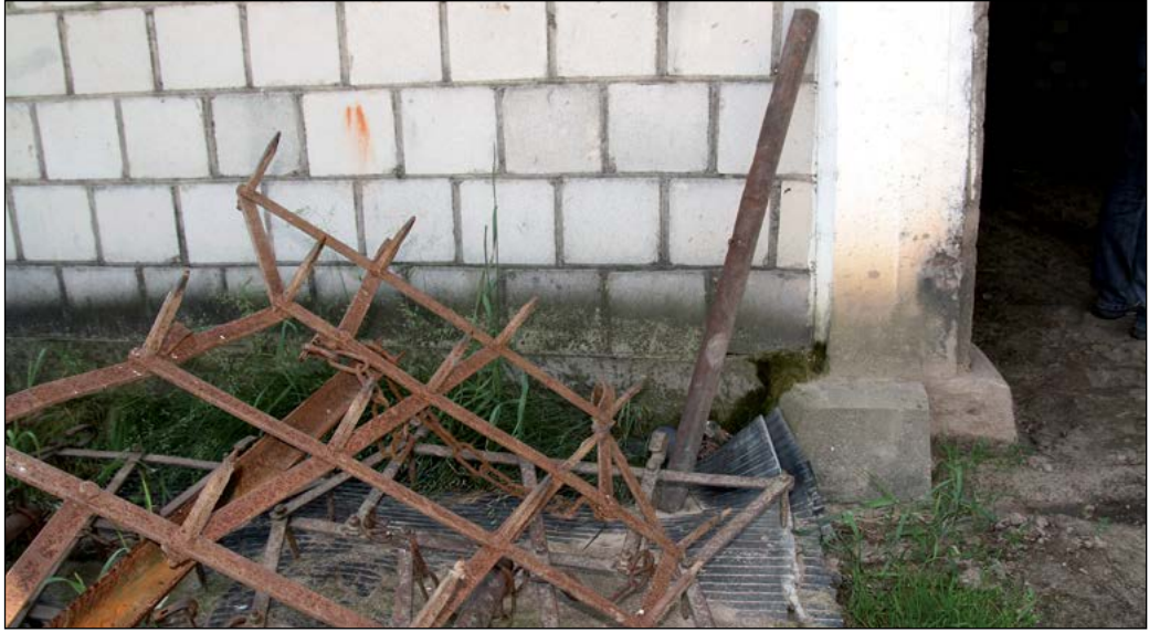
Fot. 6. Czy wiesz, dlaczego ta broń stwarza zagrożenie? Jest źle odłożona. Osoba wychodząca z budynku mogłaby potknąć się na nierównej nawierzchni i upaść na jej ostrza. Maszyny i narzędzia takie, jak to, należy kłaść zawsze ostrymi elementami do dołu i przechowywać w wyznaczonych do tego miejscach.
