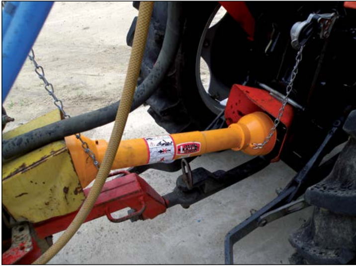
Fot. 8. Wałek łączący maszyną rolniczą z ciągnikiem musi być osłonięty na całej długości. Osłona powinna być nieuszkodzona oraz zabezpieczona łańcuszkami przed obracaniem, w przeciwnym razie nie spełni swej funkcji – nie ochroni przed pochwyceniem części ciała lub ubrania przez wirujący, napędzany z dużą mocą wałek.
