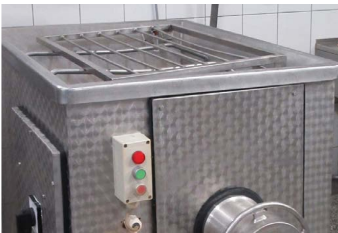
Fot. 2 Maszyna do mielenia mięsa typu wilk wyposażona w osłonę napędu, pokrwywę kosza zasypowego z urządzeniem powodującym automatyczną blokadę pracy wilka przy otwartej pokrywie oraz właściwy układ sterowania. Przykład maszyny dostosowanej do wymagań minimalnych.
