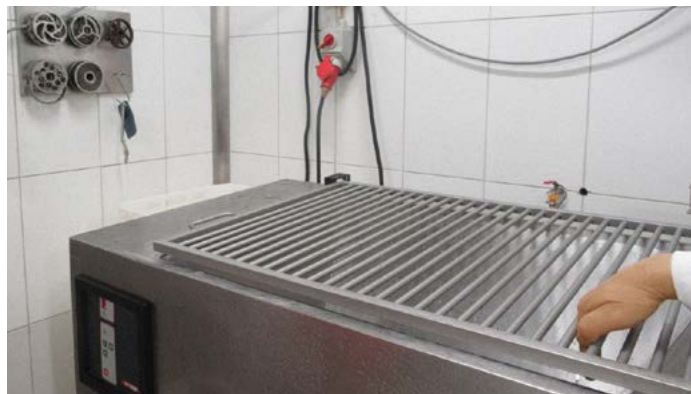
Fot. 4 Prawidłowe zabezpieczenie kosza zasypowego wilka przed możliwością pochwycenia dłoni operatora.
