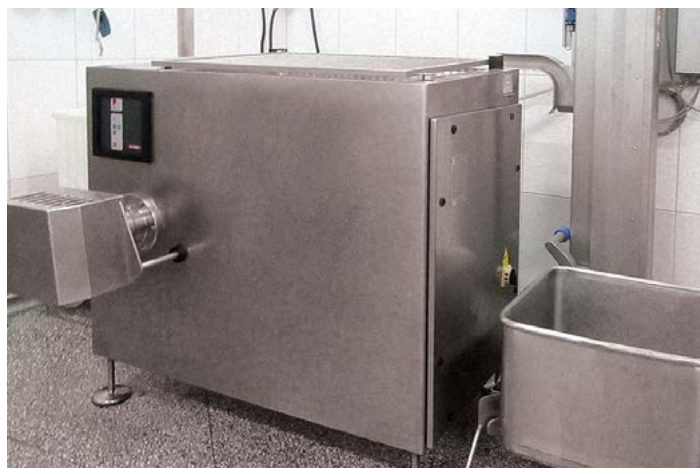
Fot. 3 Maszyna do mielenia mięsa typu wilk z mechanicznym zasypem surowca wyposażona w osłonę napędu, pokrwywę kosza zasypowego z urządzeniem powodującym automatyczną blokadę pracy przy otwartej pokrywie, osłonę gardzieli, we właściwy układ sterowania oraz w łatwo rozpoznawalne urządzenie do odłączania od źródła energii. Przykład maszyny spełniającej wymagania zasadnicze.
