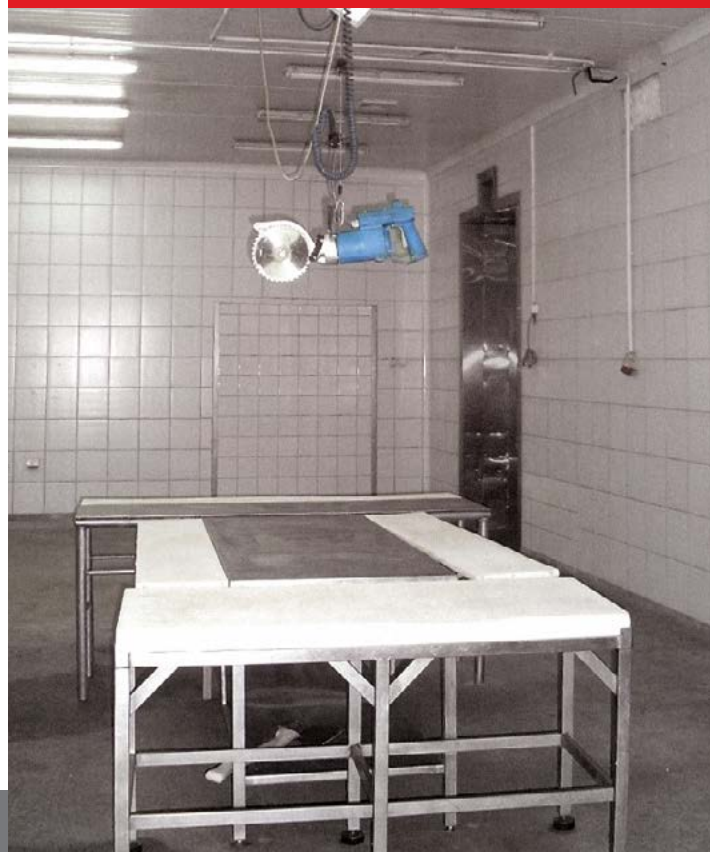
Fot. 6 Stanowisko dzielenia półtuszy z podwieszoną piłą tarczową. Piła wyposażona w osłonę tarczy oraz przeciwwagę.
