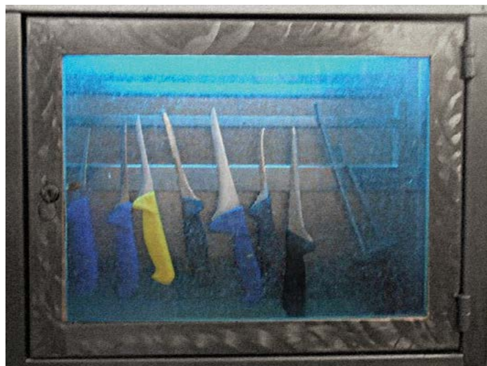
Fot. 5 Zabezpieczenie noży w sterylizatorze po zakończonej pracy przed dostępem osób nieupoważnionych.
