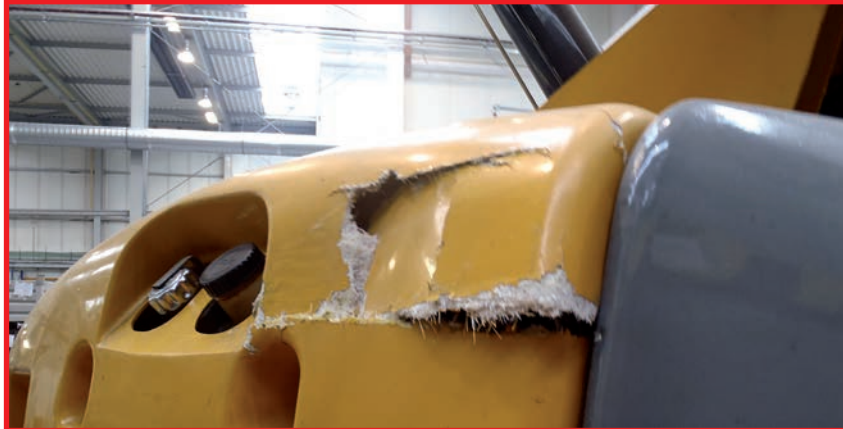
Mechaniczne uszkodzenia obudowy to skutek braku widoczności w strefie manewrowania wózkiem.
