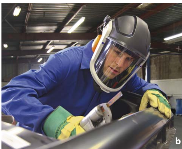
Fot. 10. Przykłady sprzętu ochrony układu oddechowego z wymuszonym przepływem powietrza: a lekki sprzęt zalecany do ochrony przed bakteriami, wirusami; b jednoczesna ochrona oczu i twarzy oraz układu oddechowego przed pyłami o dużej energii, szczególnie zalecana do prac związanych z czyszczeniem dużych, silnie zabrudzonych elementów.
