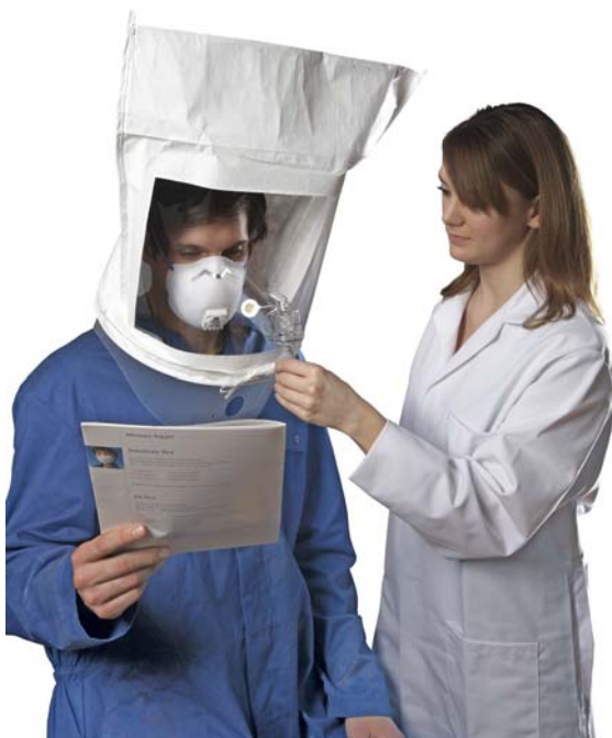
Fot. 7. Metoda indywidualnego dopasowania sprzętu ochrony układu oddechowego – np. półmaski filtrującej.
