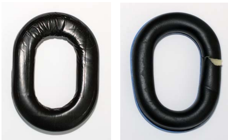
Fot. 34. Uszkodzona poduszka uszczelniająca nauszника przeciwhałasowego.
