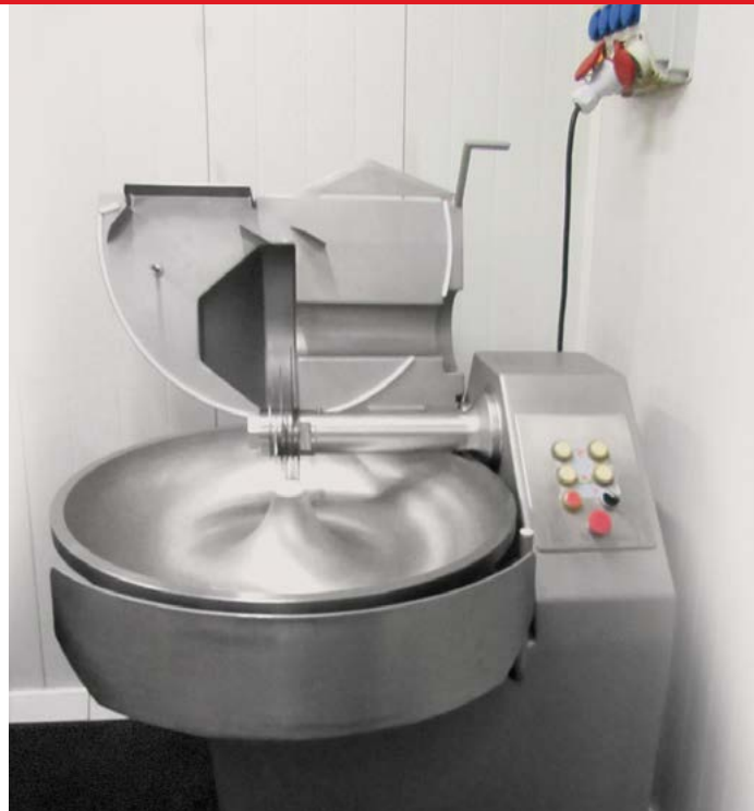
Fot. 1, 2 Maszyna typu kuter wyposażona w osłony napędu, pokrywę misy z urządzeniem powodującym automatyczną blokadę pracy przy otwartej pokrywie oraz właściwy układ sterowania. Przykład maszyny dostosowanej do wymagań minimalnych. ▼
