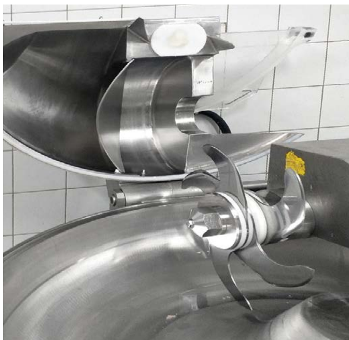
Fot. 4 Strefa niebezpieczna pracy kutra – noże stanowiące element wymienny urządzenia.
