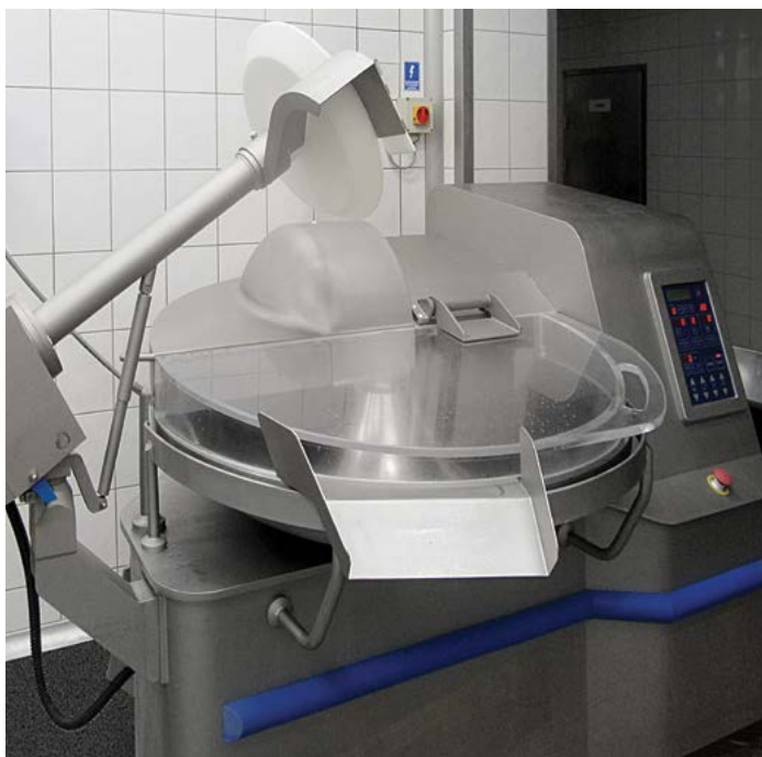
Fot. 3 Maszyna typu kuter wyposażona w osłony napędu, pokrywę miski z urządzeniem powodującym automatyczną blokadę pracy przy otwartej pokrywie oraz właściwy układ sterowania. Przykład maszyny spełniającej wymagania zasadnicze.
