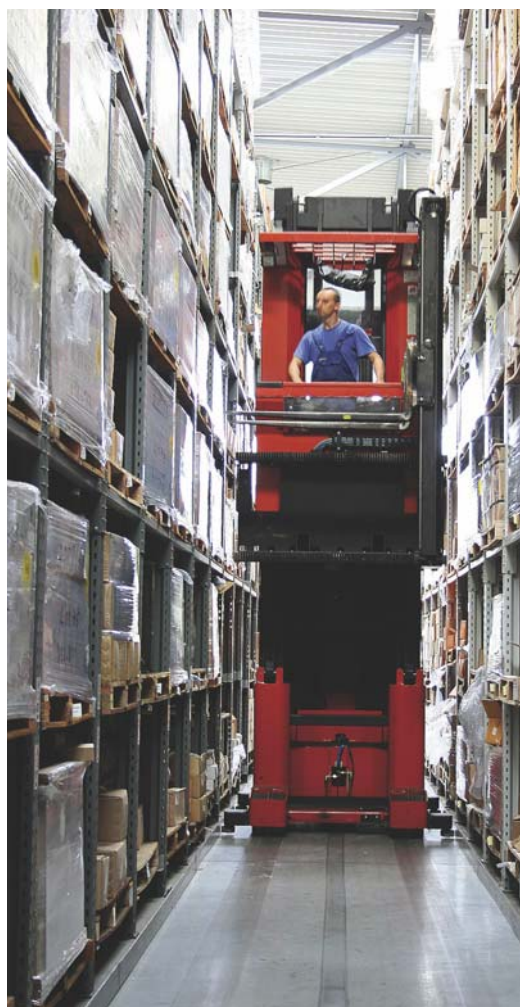
Fot. 12. Wózek jezdniowy podnośnikowy z operatorem podnoszonym wraz z ładunkiem.
