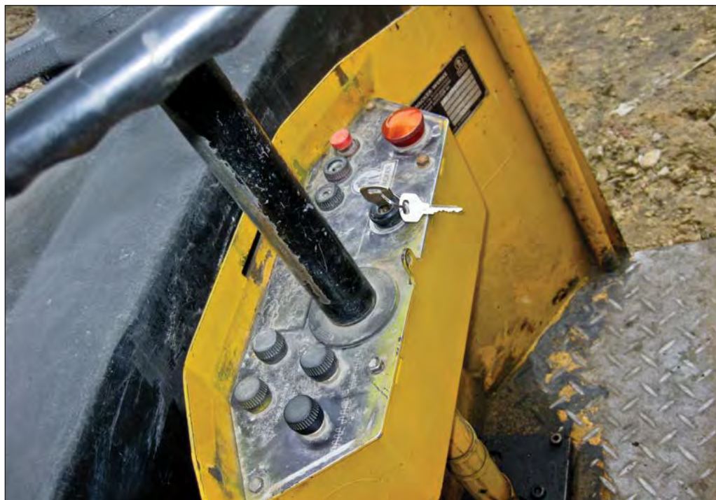
Nie wolno pozostawiać urządzeń bez nadzoru z kluczykami w stacyjce.
