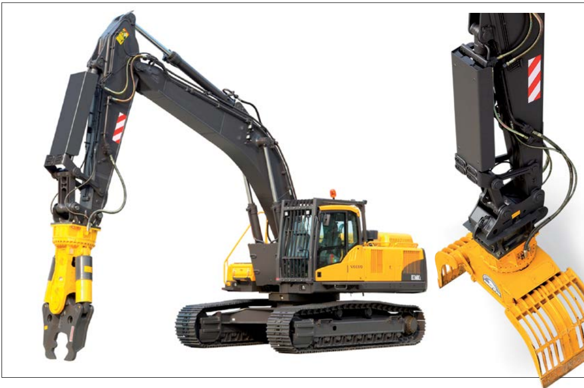
Ciężki sprzęt budowlany używany podczas rozbiórek mechanicznych wyposażony jest w specjalistyczny osprzęt: po lewej – koparka z nożycami, po prawej – koparka zaopatrzona w szczęki.
