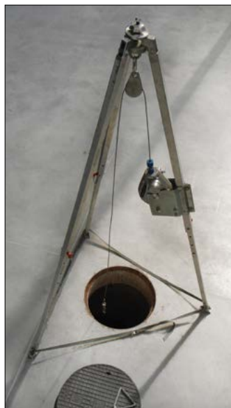
Fot. 42. Trójnóg ratowniczy nad studzienką.
