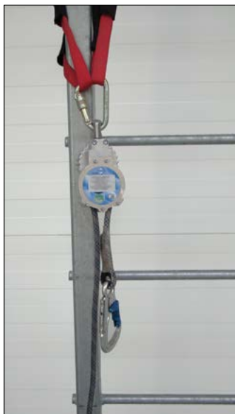
Fot. 43. Urządzenie Autoewak w zbliżeniu.
