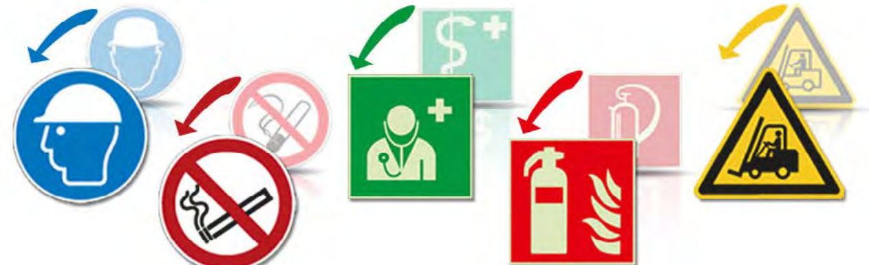
Piktogramy w znakach bezpieczeństwa wg PN-EN ISO 7010. Od lewej: nakaz stosowania ochrony głowy, zakaz palenia tytoniu, lekarz, gaśnica, ostrzeżenie przed urządzeniami do transportu poziomego.
