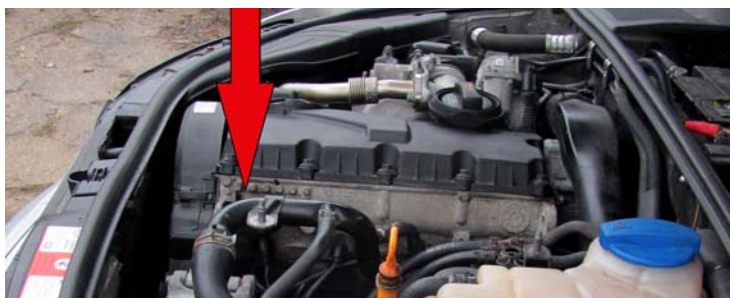
Komora silnika przy zdemontowanej osłonie wygłuszającej. Strzałką zaznaczono miejsce w korpusie głowicy usuwanej świecy żarowej.
