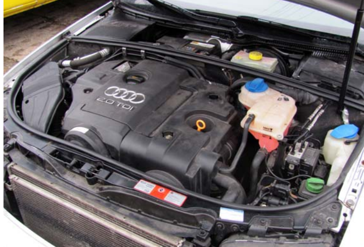
Komora silnika naprawianego samochodu. Od góry do silnika jest przykręcona osłona wygłuszająca, nieoryginalna, tj. od silnika 2.0 tdi. Przy tej osłonie brak jest dostępu do miejsca usytuowania świec żarowych.
