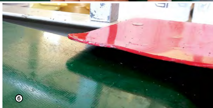
5. Osłona zamontowana w miejscu nabiegania taśmy na wałek prowadzący. Strzałką zaznaczono miejsce dostępu do strefy pochwylenia po ominięciu osłony. 6. Osłona zamontowana w miejscu nabiegania taśmy na wałek prowadzący.
