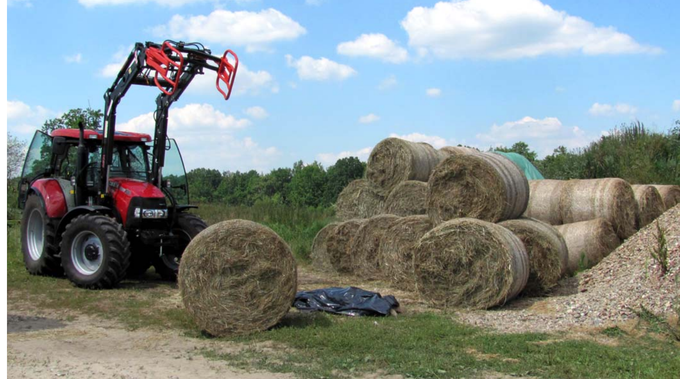
Miejsce wypadku – uszkodzony został uderzony balotem siana, który wysunął się z ramion uniesionego chwytaka ciągnika.
