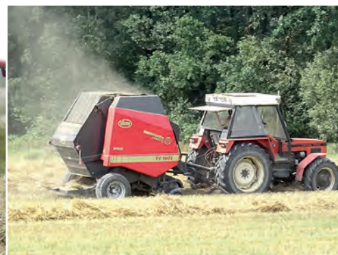
Prasy rolujące wyparty ciężką pracą fizyczną przy załadunku słomy na przyczepy, co wyeliminowało konieczność dowożenia ludzi do tej pracy. Obecnie na polu potrzebni są operatorzy maszyn.
