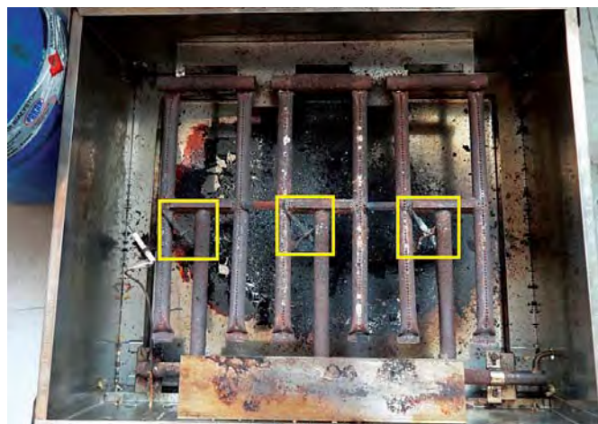
Elementy grilla gazowego, wyposażonego na każdym palniku w elementy zabezpieczenia przeciwwyływowe (oznaczone na zdjęciu żółtym prostokątem).
