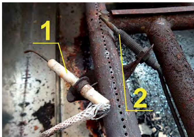
Znajdujący się w grillu gazowym iskrownik (nr 1) i zabezpieczenie przeciwwyływowe gazu (nr 2).
