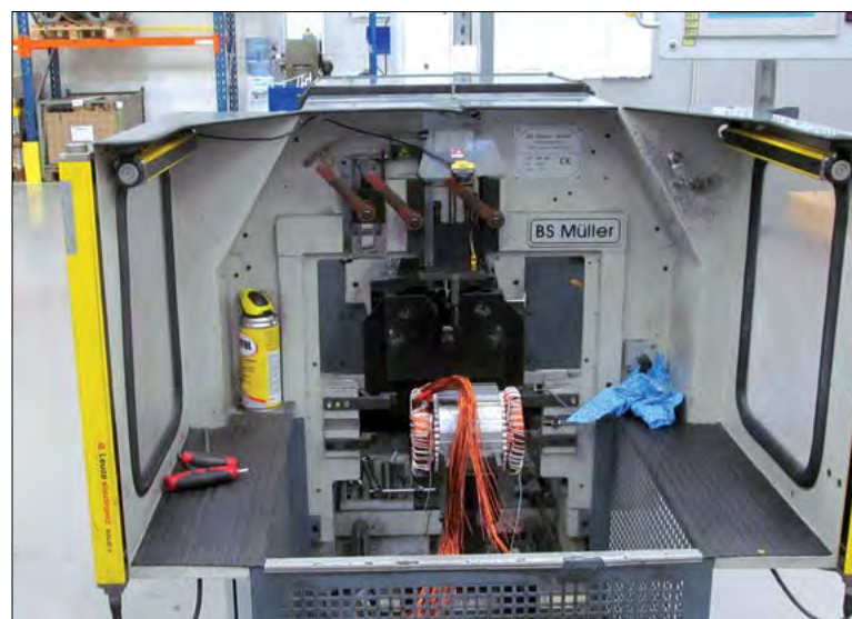
Przykład maszyny wyposażonej w dwie kurtyny świetlne zainstalowane prostopadle i równoległe do kierunku zbliżania rąk operatora
