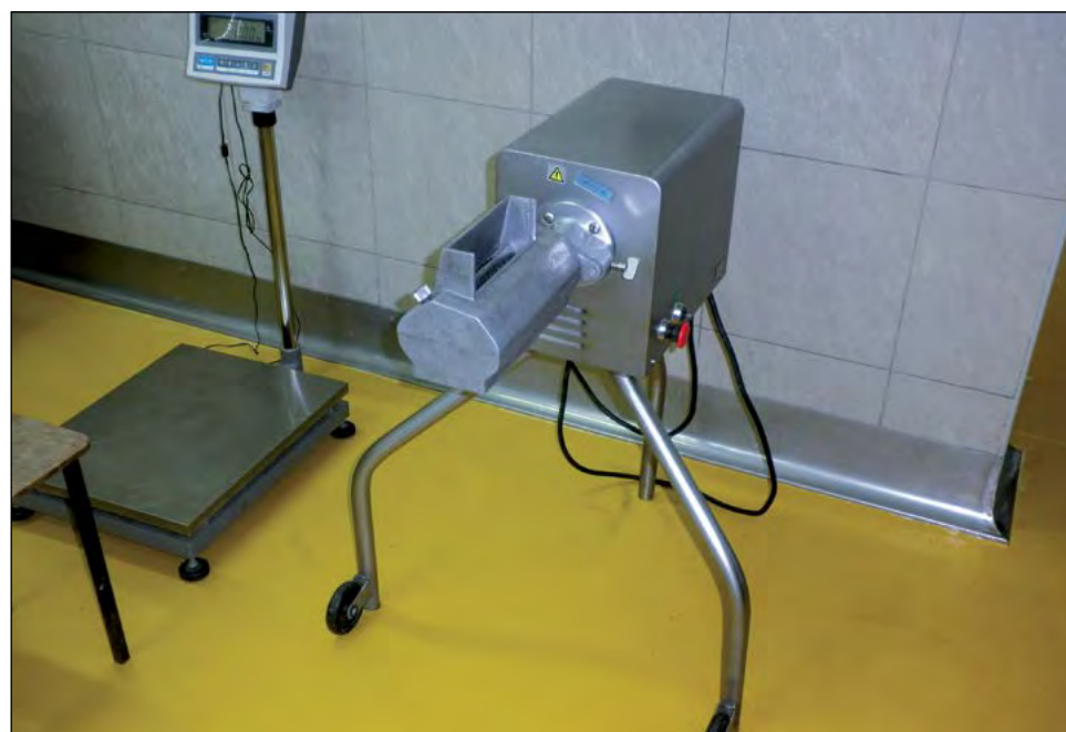
Maszyna kuchenna wieloczynnościowa typ NMK 110 nr seryjny: 7 3154 produkcji Nakielskich Zakładów Maszyn i Urządzeń Gastronomicznych „Spomasz”, z przystawką do nacinania kotletów MKS 50 W (bez numeru seryjnego i oznaczeń). Data produkcji: 2008. Maszyna oznakowana znakiem „CE”
