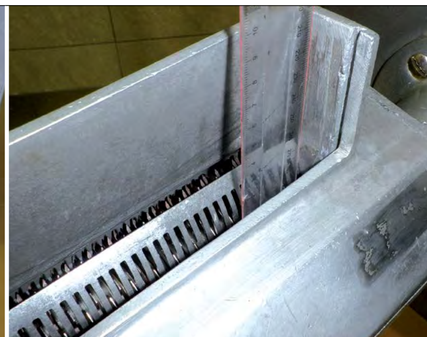
Widok przystawki MKS 50 W. W gardzieli linijka wskazująca na odległość od krawędzi do zespołu krążków - 35 mm. Widoczne miejsce montażu wsypu oznaczone strzałką
