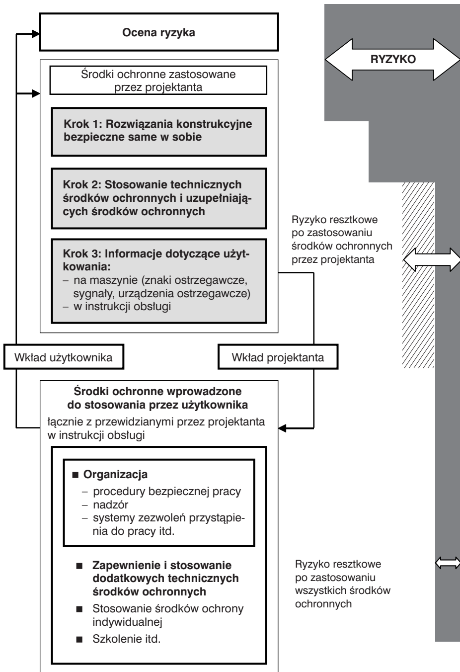
Rys. 3. Wpływ producenta (projektanta) i pracodawcy na ryzyko zawodowe przy użytkowaniu maszyn [2]
