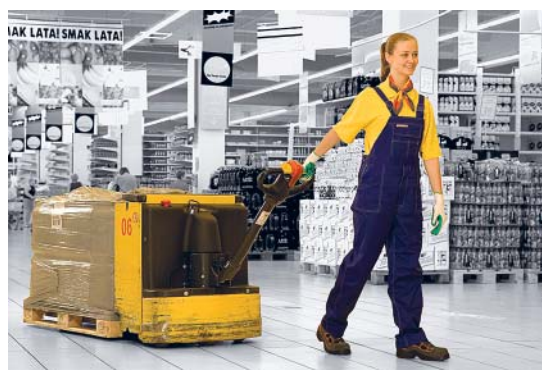
Ilustracja 1. Przykład wyeliminowania ręcznego przemieszczania ciężarów
