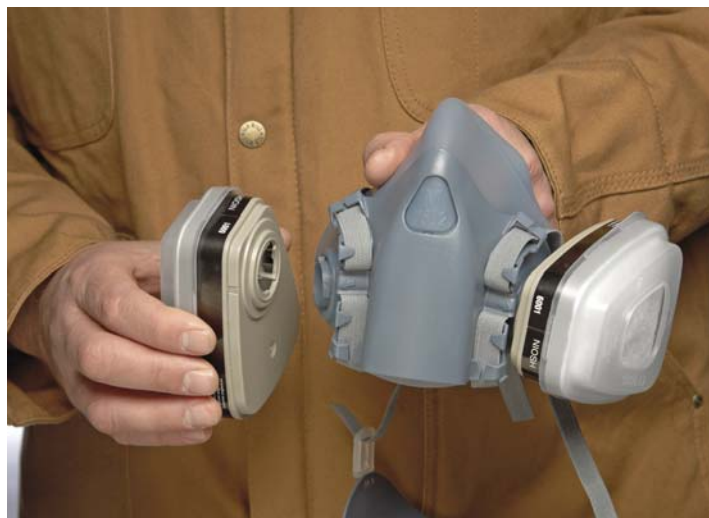
Fot 12. Wymiana zużytych elementów pochłaniających musi być dokonana przez pracownika w środowisku wolnym od zanieczyszczeń gazów lub par szkodliwych substancji chemicznych.
