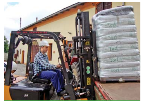
Umieszczanie ładunku na przyczepie (bez jego przesuwania po podłodze).
