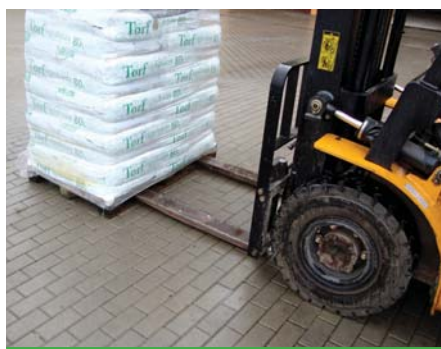
Umieszczanie palety na widłach przed podniesieniem ładunku.
