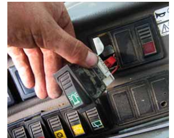
Na fotografii przekazanej przez firmę RUDA Trading (autoryzowany serwis) widoczne jest niezabezpieczone połączenie przewodów przy kostce łączeniowej oraz dodatkowy przewód zasilający włączony pod przycisk „koguta”
