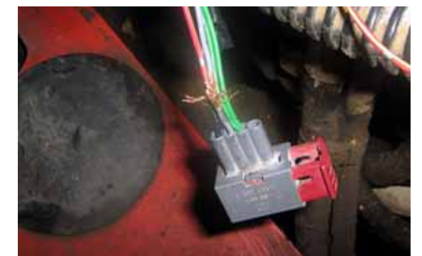
Na fotografii przekazanej przez firmę RUDA Trading (autoryzowany serwis) widoczne jest niezabezpieczone połączenie przewodów przy kostce łączeniowej oraz dodatkowy przewód zasilający włączony pod przycisk „koguta”
