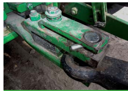
Zabezpieczenia sworznia zaczepowego przed wypadnięciem po zagregowaniu ciągnika z rozrzutnikiem.
