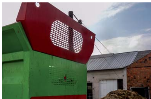
Siatka ochronna na przedniej burcie chroni przed twardymi przedmiotami podczas roztrząsania obornika.
