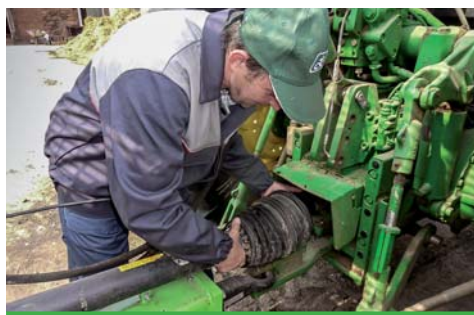
Podłączenie wału przegubowo-teleskopowego do napędu rozrzutnika.
