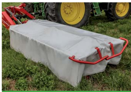
Fartuch ochronny kosiarki nie może być uszkodzony.
