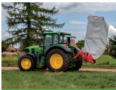
Przejazd z kosiarką w położeniu transportowym.
