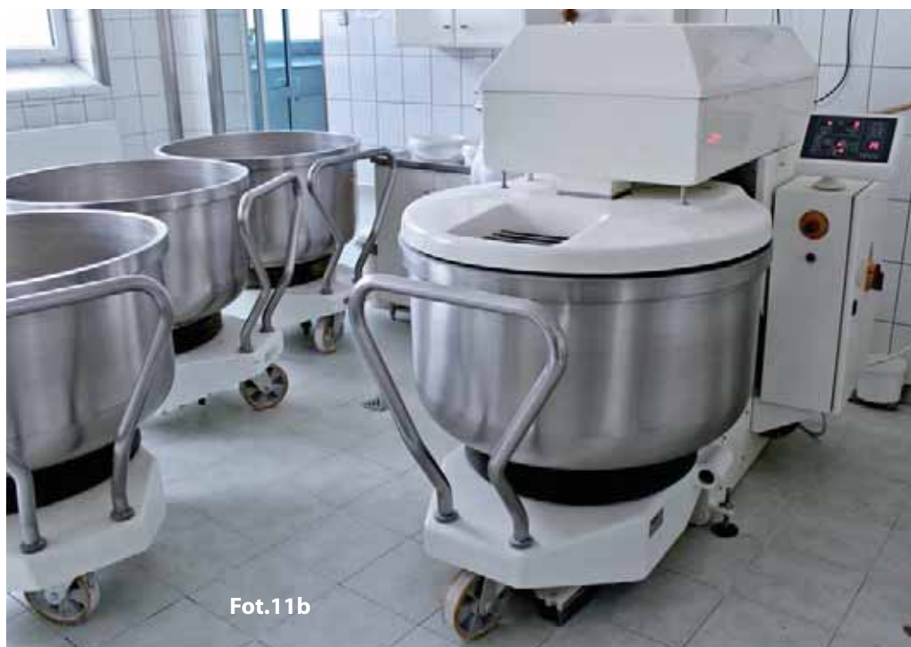
Fot. 11a i 11b. Dzieże do ciasta wyposażone w koła ułatwiające transport ciasta na terenie zakładu.
