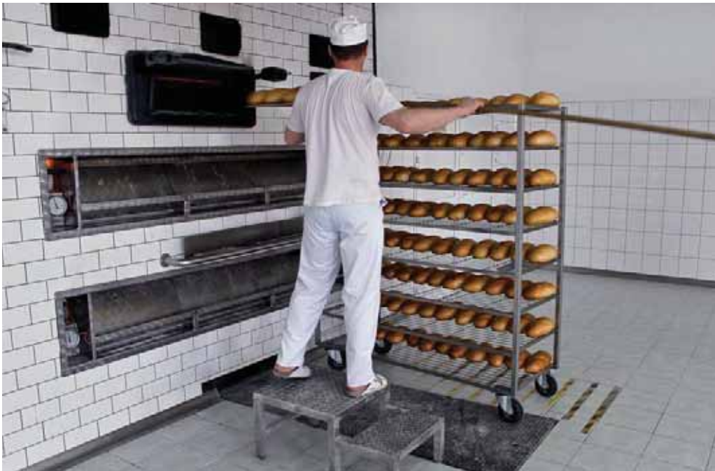
Fot. 5. Wymywanie pieczywa z górnej komory załadunkowej pieca z podestu roboczego.
