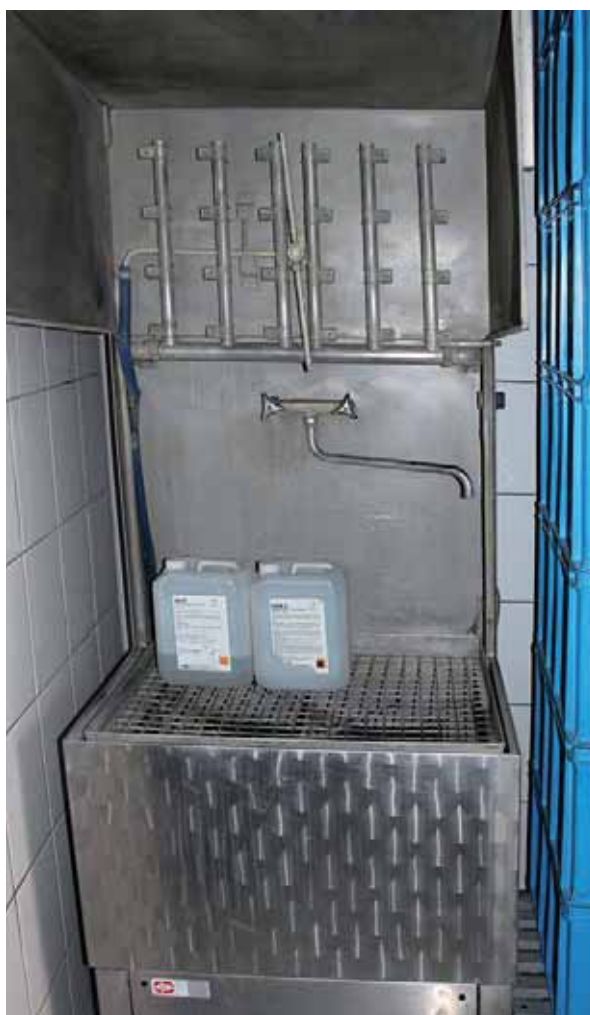
Fot. 7. Myjka automatyczna eliminująca narażenie pracownika na środki czyszczące i dezynfekujące.
