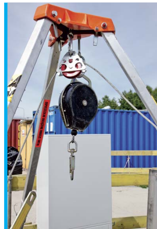
Urządzenie umożliwiające ewakuację nieprzytomnego pracownika.
