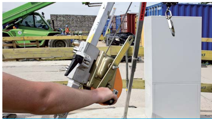
Urządzenie umożliwiające ewakuację nieprzytomnego pracownika.
